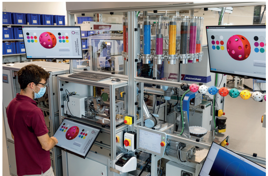
Vollautomatisierte Fertigungszelle zur Produktion eines Unihockeyballs im Technikum des IWK in Rapperswil © Ostschweizer Fachhochschule
